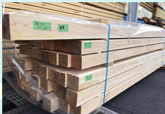
桧 4.0M 120×120 (6束) KD 2上小ほか 1B/L 桧 3.0M 120×120 (24束) KD 3ム、2ム、ム3上ほか 1B/L 桧 3.0M 105×105 (17束) KD 3ム、2ム、ム3上ほか 1B/L
